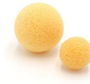
Der Durchmesser der Kugel sollte 10 - 20% größer gewählt werden als der Innendurchmesser des Rohres (bei Härte mittelfest).
